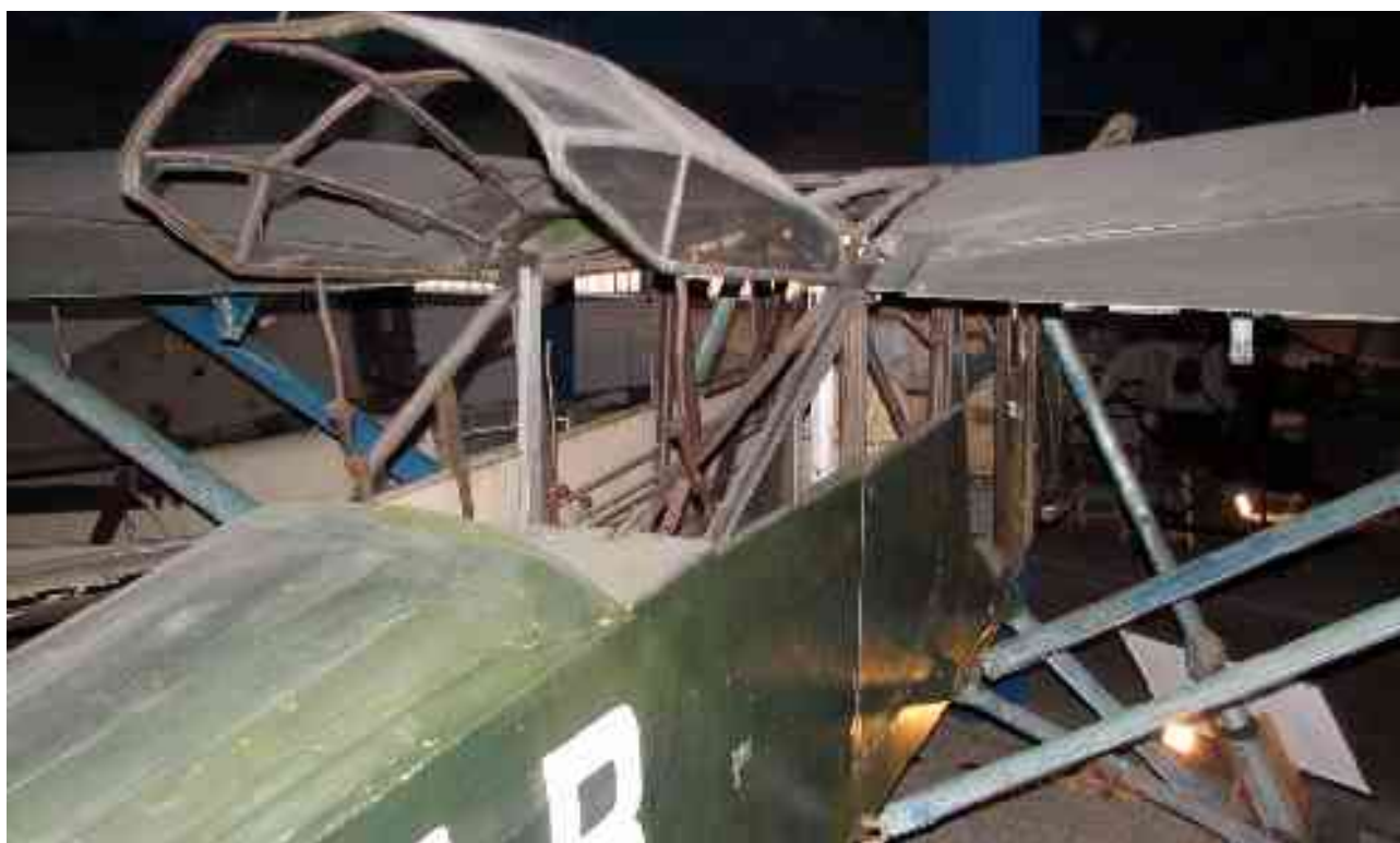
Fot. Samolot typu LWD Żuraw - stan zachowania kabiny pilotów oraz płatów od linii splywu.
