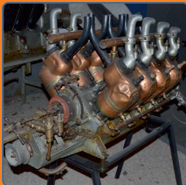
Armatura silnika: pompa paliwowa i regulator kąta wyprzedzenia zapłonu
