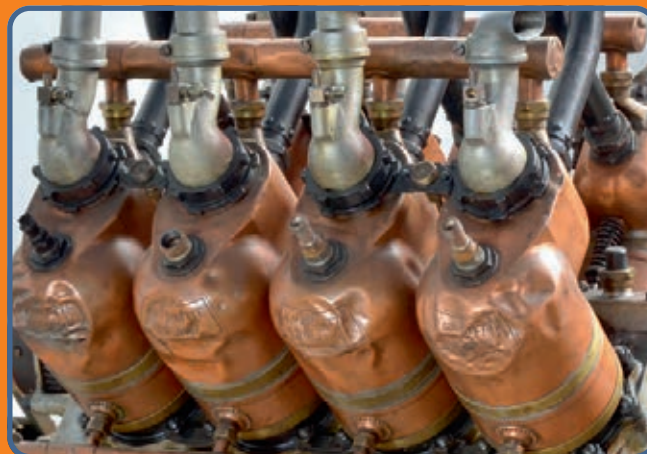
Blok cylindrów z wytłoczonym znakiem producenta
